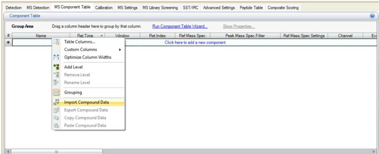
Abbildung 5: NIST Datenbank lassen sich in Chromeleon™ importiert werden. In der Processing Method in Chromeleon™ lassen sich Bibliotheken aus der NIST-Software einfach mittels Rechtsklick importieren.
